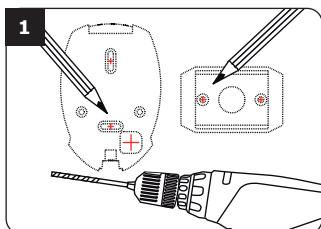
Kontrollera avståndet mellan GALEO kodlås och styrenhet (Se sid 3 «Information och rekommendationer»). Sätt kodlåsets bakstycke och styrenhetens monteringsplatta mot väggen och markera hålens placering med en penna. Borra sedan två monteringshål och hål för kabeln ( $\varnothing$  5 mm bits och min. djup 35 mm).
