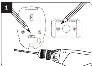
Kontroller afstanden mellem GALEO-kodelåsen og styreenhed (se side 26, Information og anbefalinger). Placer låsens bagdæksel og monteringspladen til styreenheden mod væggen, og markér hullernes placering med en pen. Bør derefter to monteringshuller og hul til kablet ( $\varnothing$  5 mm. bits og min. dybde 35 mm.).
