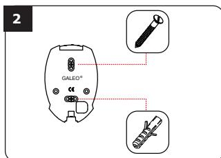
Sätt plastpluggar i de borrade hålen. Placera kodlåsets bakstycke mot väggen och skruva fast med de bifogade monteringsskruvarna (M4x30).
