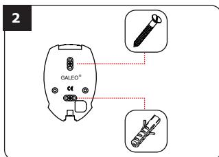
Sæt plastikplugs i de borette huller. Placer kodelåsns bagplade mod væggen og skru det fast med de medfølgende monteringskruer (M4x30).
