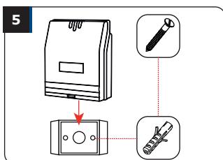
Sæt de 2 plastikplugs i hullerne. Anbring monteringspladen til styreenheden på væggen og skru det fast med de medfølgende M4x30-skruer. Monter styreenheden på monteringspladen, oppefra og ned.
