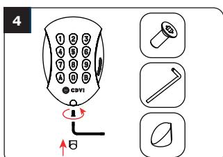
Skruta fast knappsatsen med M4x10 TORX® skruv och T20 nyckel. Sätt dit skruvens täcklock i nederkant av knappsatsen.
