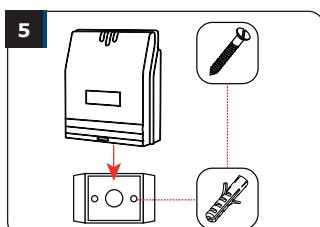
Sätt plastpluggar i de borrade hålen. Skruva fast styrenhetens monteringsplatta mot väggen och skruva fast med M4x30 skruvar. Försätt styrenheten uppifrån och ner för att haka fast den på monteringsplattan.
