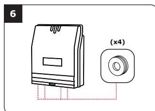
Indsæt kablet i styreenheden og slut det til koblingsterminalerne. Glem ikke at installere varistoren på låsen. (Se side 26, Information og anbefalinger).
