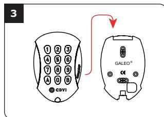
Før GALEO-kablet gennem kabelhullet i bagdækslet. Monter tastaturet på bagdækslet, oppefra og ned.
