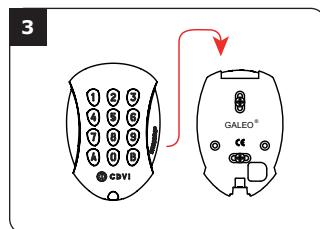
Trä GALEO-kabeln genom kabelhålet i bakstycket.
